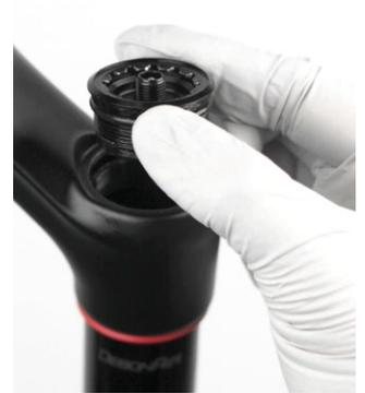
**2** Quite la junta tórica de la tapa superior. Instale una junta tórica nueva. No aplique grasa a las roscas de la tapa superior.
