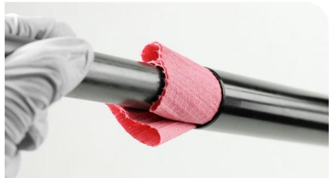
**7** Retire el cabezal de sellado del eje neumático.
