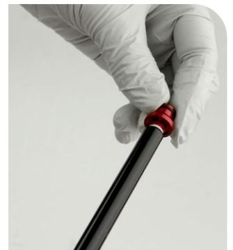
**4** Sujete el tubo del cartucho del Rush Damper en un tornillo de banco usando los bloques adaptadores de banco Reverb. Tire del eje del amortiguador hasta extenderlo completamente.
