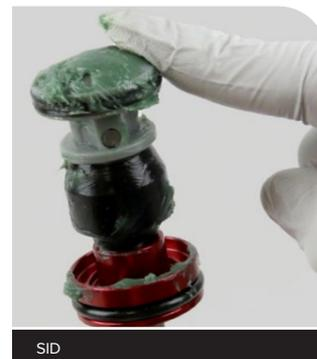
**13** Inserte el conjunto de resorte neumático en el tubo superior. Empuje firmemente el pistón neumático dentro del tubo superior.
