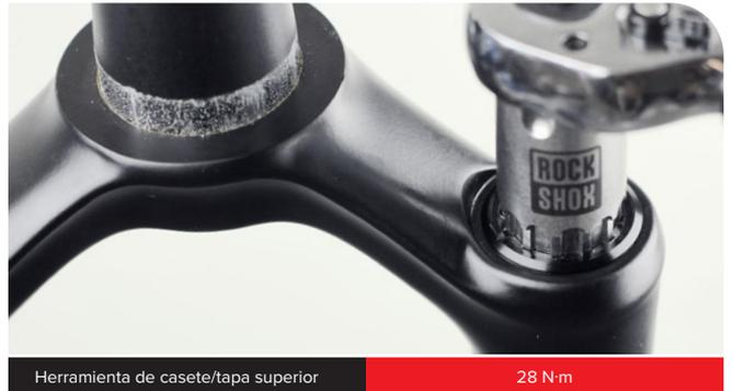
**Mantenimiento cada 200 horas** Siga con [Mantenimiento del Charger Race Day Damper](#) cada 200 horas.
