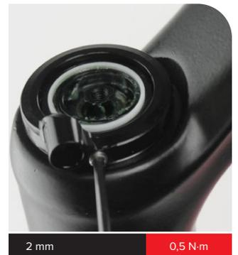
Instale el carrete del control remoto en el ajustador hexagonal con el tornillo de fijación del cable orientado  $\approx 110^\circ$  desde la guía de la funda.
