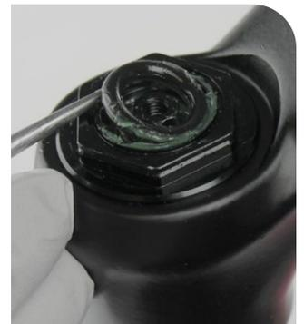
**3** **RL R:** Afloje el tornillo de fijación y retire el carrete del cable y el collarín de tope del cable.
