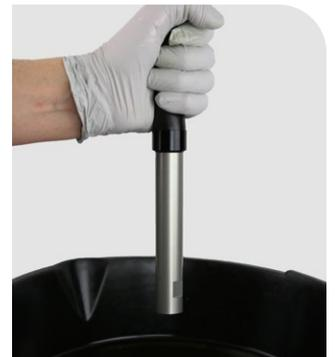
**8** Pulverice limpiador de suspensiones RockShox o alcohol isopropílico en el tubo del cartucho.
