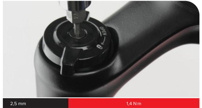
**4** **RL R:** Instale el collarín de tope del cable con la guía de la funda orientada hacia fuera. Apriete el tornillo de fijación.
