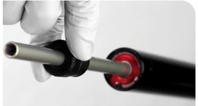
**4** Empuje el eje neumático dentro del tubo superior para evitar que se arañe al retirar el anillo de retención.
