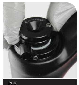
Instale y apriete el tornillo de retención del carrete del control remoto. Consulte el manual de usuario correspondiente en [www.sram.com/service](http://www.sram.com/service) para obtener instrucciones de instalación del cable y el control remoto.
