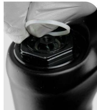
**4** Desenrosque la tapa superior del amortiguador y retire el conjunto del amortiguador.
