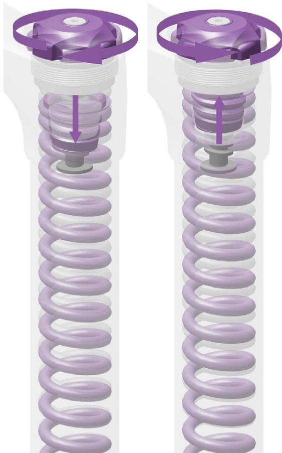
El ajuste externo de precarga del resorte lo comprime o descomprime sin llegar a iniciar el recorrido.
