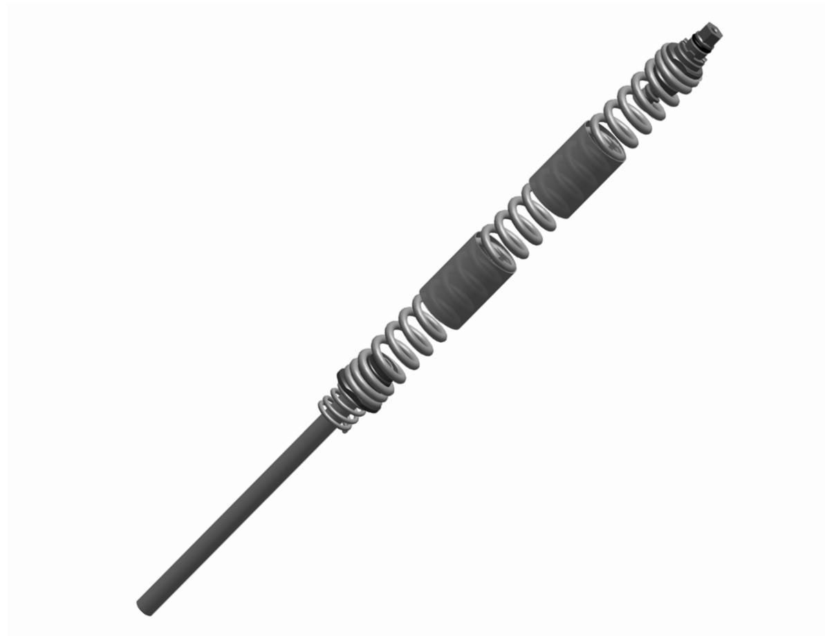
El ajuste de precarga del resorte permite regular con precisión la caída, pero no cambia su tasa de resorte ni sustituye el peso del resorte helicoidal correcto.
