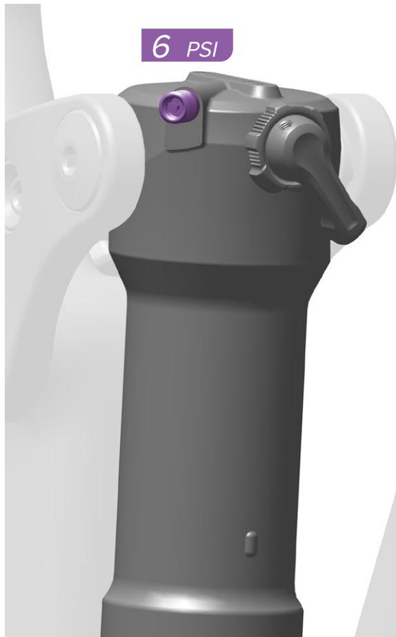
Presurice el amortiguador hasta una presión (en PSI) equivalente al peso total del piloto (en libras), incluido su equipo.
