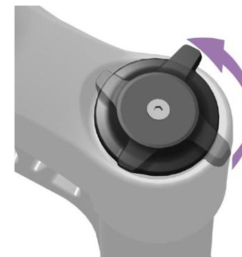
Para **aumentar** (+) la amortiguación de compresión de baja velocidad (mayor dureza), gire el mando del regulador de compresión **en sentido horario**.
