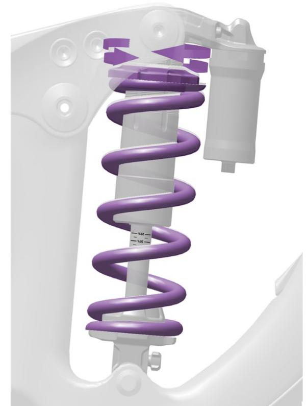
Si **no** llega a conseguir el porcentaje de caída deseado, gire el anillo de ajuste de precarga y repita el proceso de medición hasta alcanzarlo.
