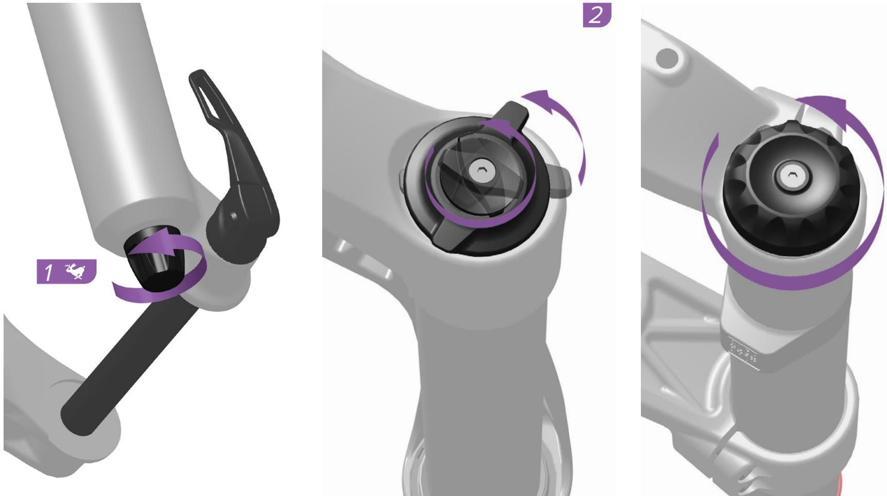
Antes de ajustar la caída, coloque los amortiguadores en posición de apertura total. Gire a tope los reguladores en sentido antihorario.
